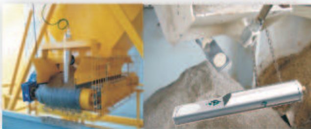
MEDICION HUMEDAD EN ARENAS - HUMIARC MEASURING MOISTURE IN SAND - HUMIARC
