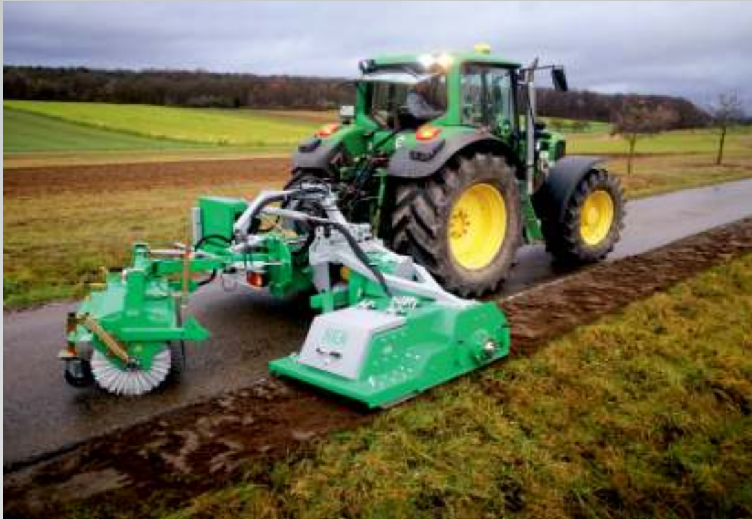
Maschine in Transportstellung, Fräskopf eingefahren
