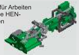
Maschine in Transportstellung, Fräskopf eingefahren
