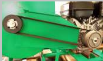
Antrieb über Keilriemen und Fliehkraftkupplung
